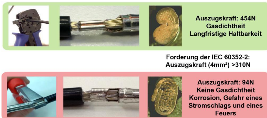
Abbildung 5: Vergleich zwischen Verbindung mit korrekter und falscher Crimpzange (Berginski, 2013)
