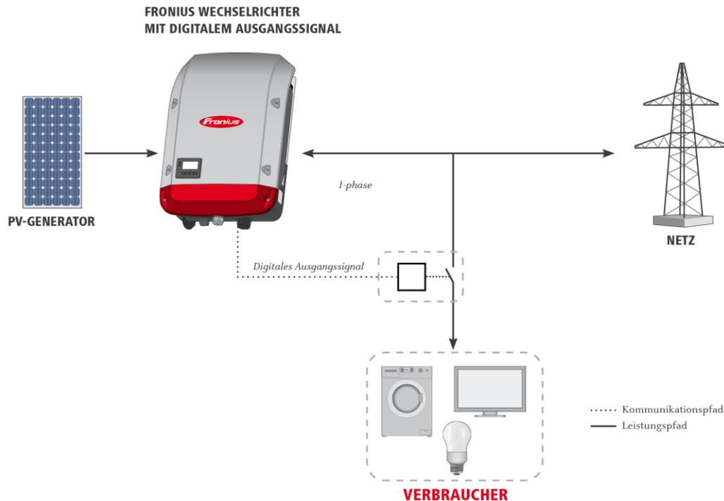
Abbildung 10 – Systemaufbau ohne Fronius Smart Meter. Steuerung anhand PV-Erzeugung. Fronius Smart Meter ist nicht nötig.
