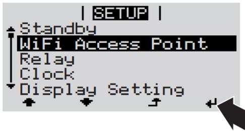
Abbildung 6 - Aktivierung des Access Point am Wechselrichter Display
