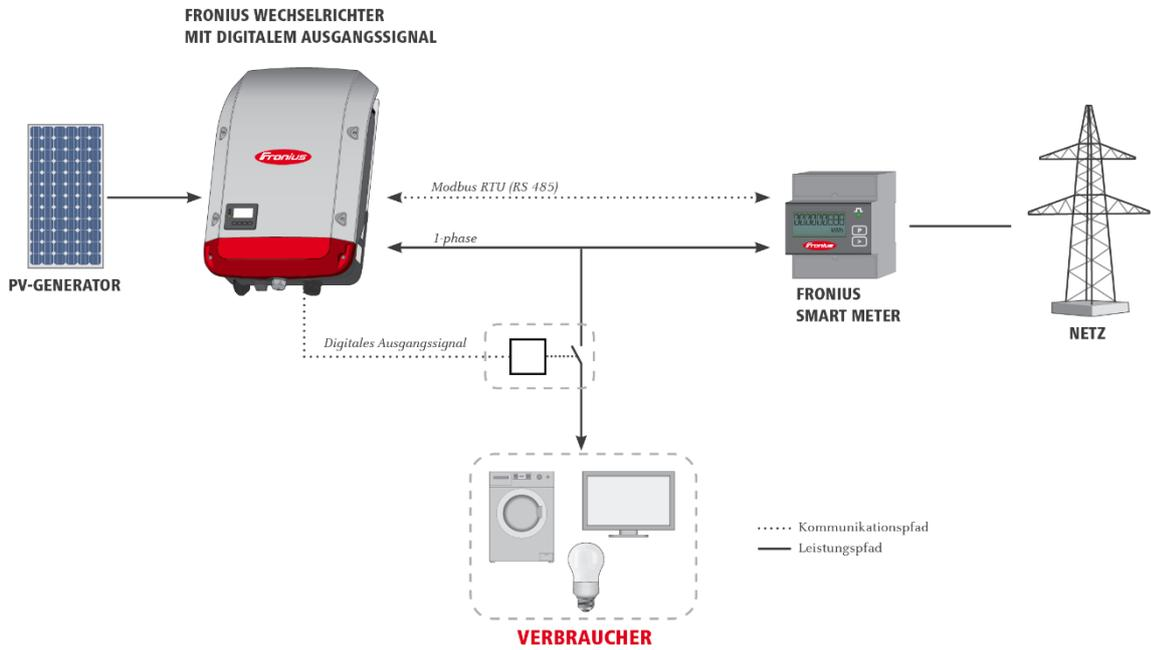
Abbildung 9 – Systemaufbau mit Fronius Smart Meter. Steuerung anhand PV-Überschuss.
